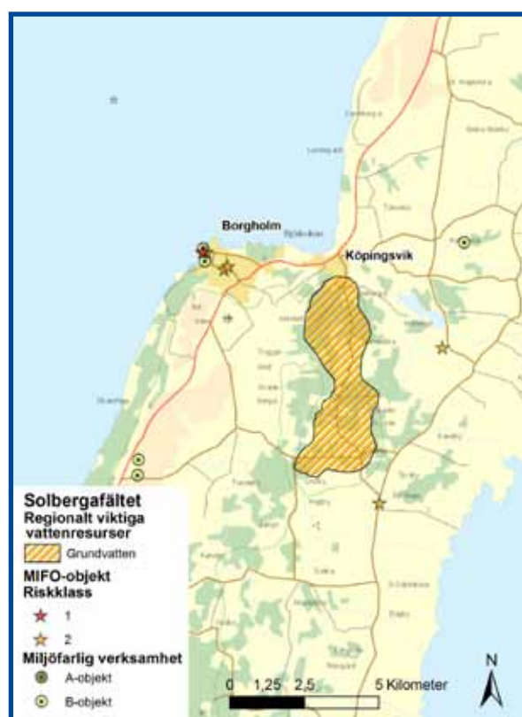
Figur 5.14. Karta över vattenresursen Solbergafältet, MIFO-objekt i riskklass 1 och 2 samt Tillståndspliktig miljöfarlig verksamhet (A- och B-objekt).
