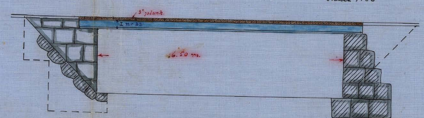
Förslag till åra vid 22+60 (järnbalkar) Skala 1:50
