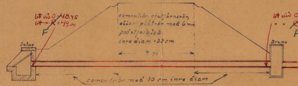
Anordnande utav nytt avlopp bredvid befintlig trumma vid F samt under järnvägen vid J i Börringe-Östratorps järnväg
