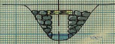
Trumma för utfartsväg mellan 1+50-1+55
